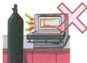
气瓶应远离热源放置
