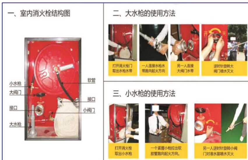
室内消火栓使用示意图
